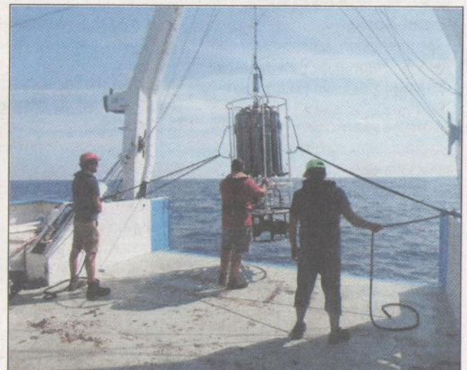
Ci-dessus à gauche, les marins mettent à l'eau le flotteur professeur. À droite, La rosette, composée de 12 bouteilles, permet de prélever de l'eau de mer à différentes profondeurs. Sous cet instrument, des capteurs permettent de mesurer: température, salinité, profondeur... (Photos S.C.)
